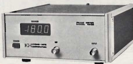
Fig. 13 - Fasometro Krohn-Hite, modello 6200, precisione 0,5°, visualizzatore continuo \pm 180^\circ , segnali sinusoidali o quadri da 10 Hz a 1 MHz.
