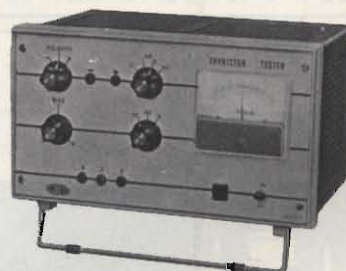
UK 808/S Apparecchio di prova per tiristori
