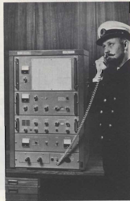
Fig. 5 - Moderno trasmettitore delle bande marine comprese nelle gamme 1600 ÷ 3800 MHz e 4 ÷ 24 MHz.
