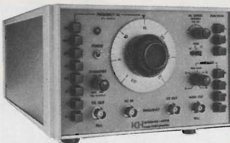
Fig. 14 - Generatore di funzione Krohn-Hite, modello 2000, per onde sinusoidali, quadre e triangolari, da 0,003 Hz a 30 MHz.
