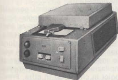
Fig. 7 - Apparecchio per la cifratura dei messaggi telex via radio, inseribile fra telescrivente e teleinseritore, modello Hell 508.
