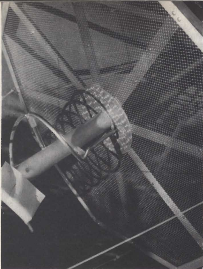
Fig. 6 - Particolare del capo caldo del radiatore dell'antenna; notare i bastoncini in plastica che irrigidiscono la struttura ad elica.
