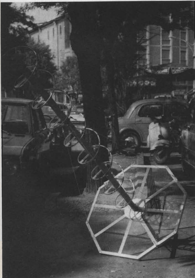
Fig. 4 - Vista d'insieme dell'antenna ad elica realizzata dall'autore per la base dell'Aeronautica Militare di Sestola; l'antenna opera nella banda di frequenze comprese fra 340 e 430 MHz.
