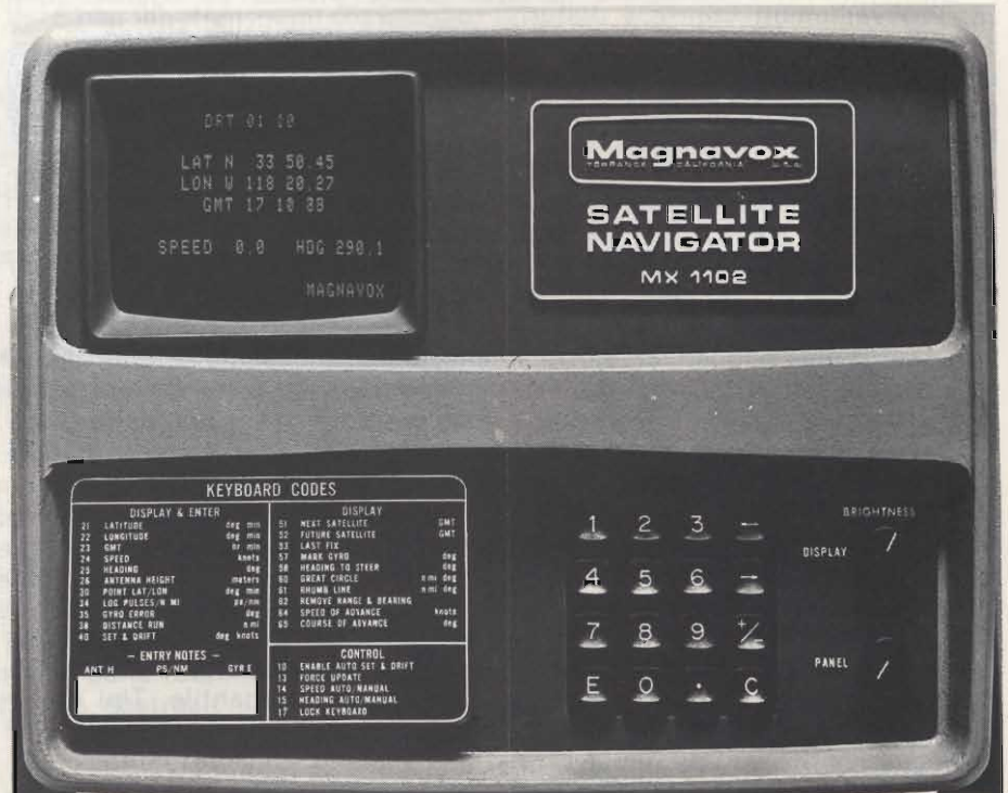
Fig. 8 - Uno fra i più moderni sistemi di radionavigazione: il Satellite Navigator modello MX 1102 (Socorama - Genova).
