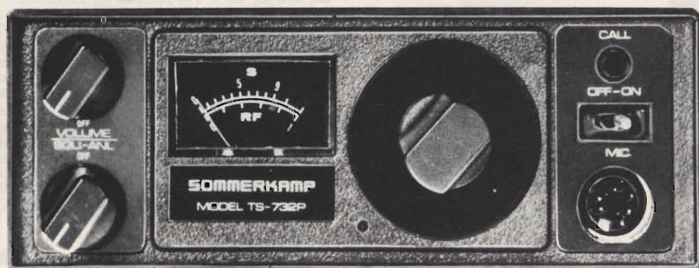
TS - 732 P 5 W - 32 canali - 11 - 16 Vcc e 110/220 Vca
